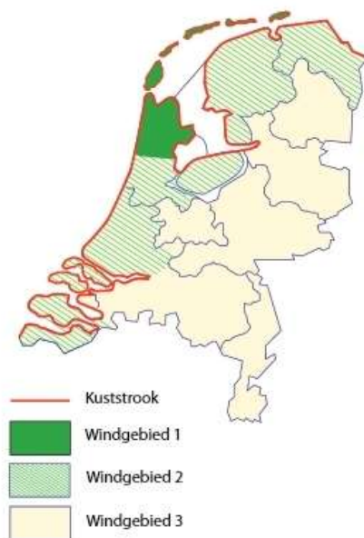
Figuur 2: Extreme stuwdruk volgens NEN-EN 1991-1-4 Windbelasting
