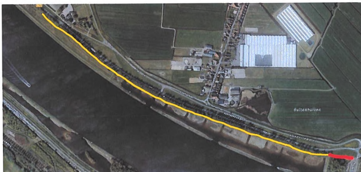
Figuur 2; Gebruik van rijplaten (geel 2 rijplaten breed en rood 4 rijplaten breed).
