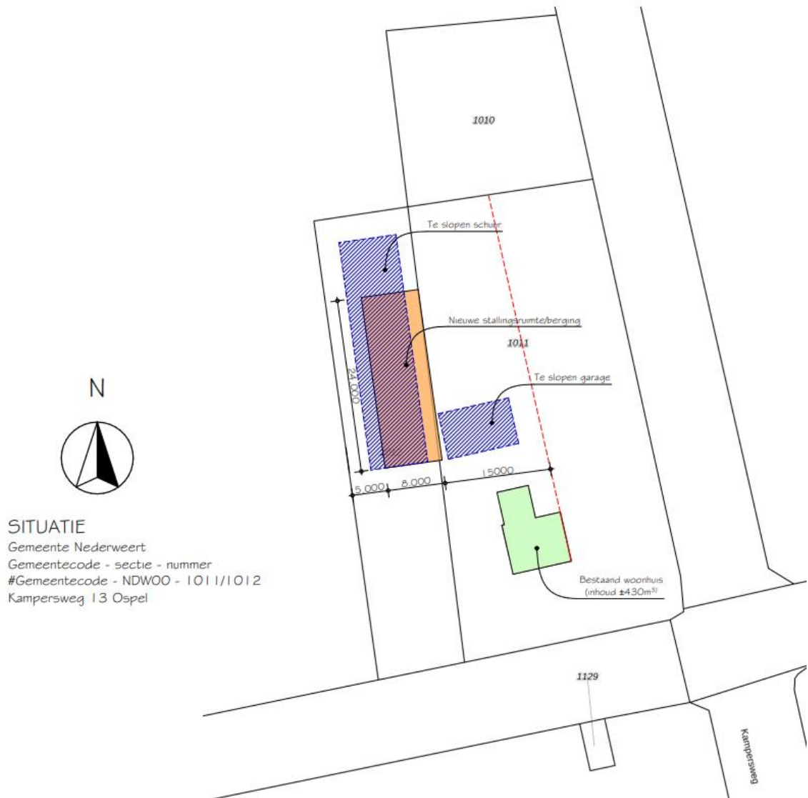
Figuur 1 - Situatietekening met sloop en nieuwbouw.
