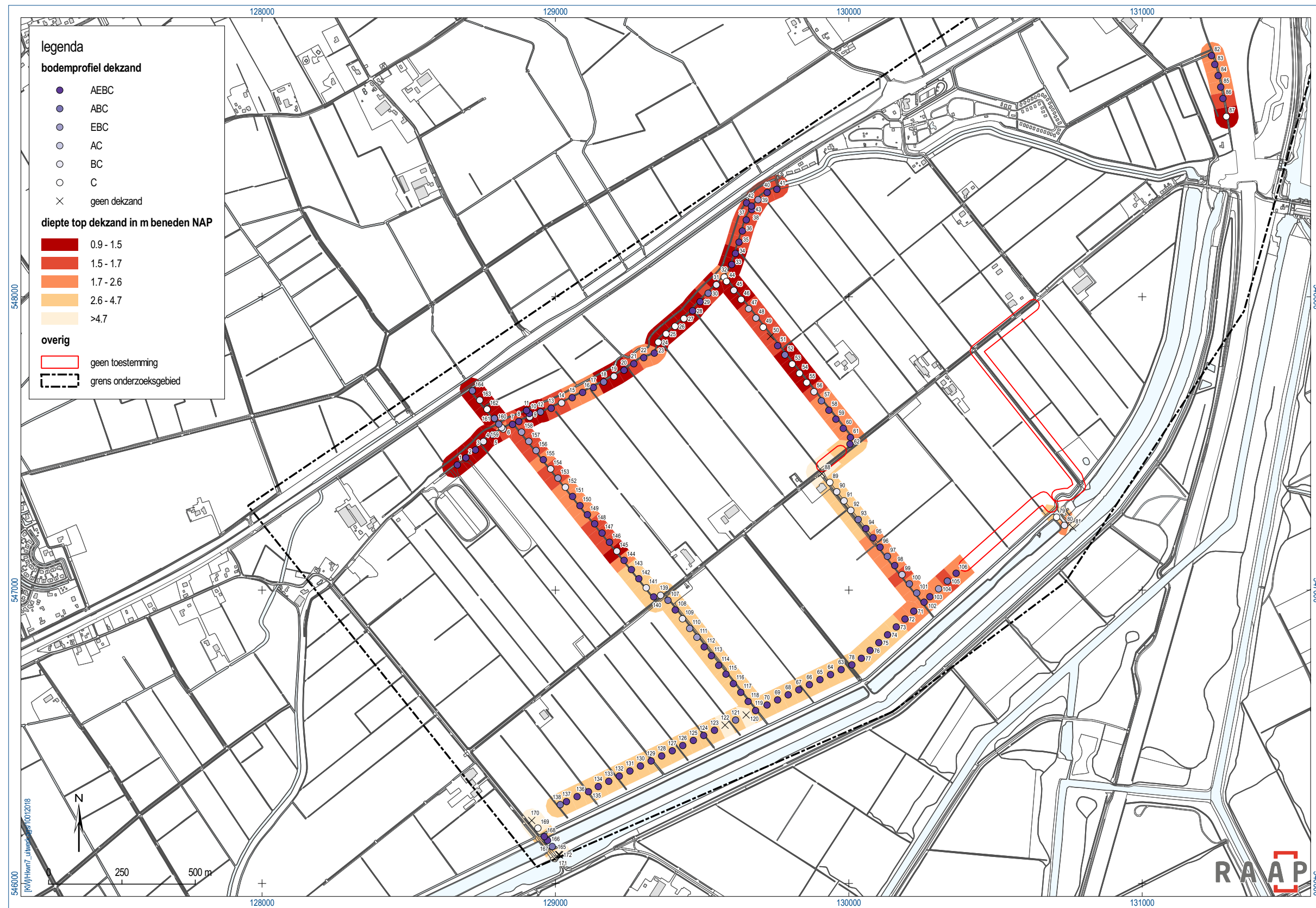
Figuur 5. Hoogtemodel top van het dekzand met waargenomen bodemprofieltypes.
