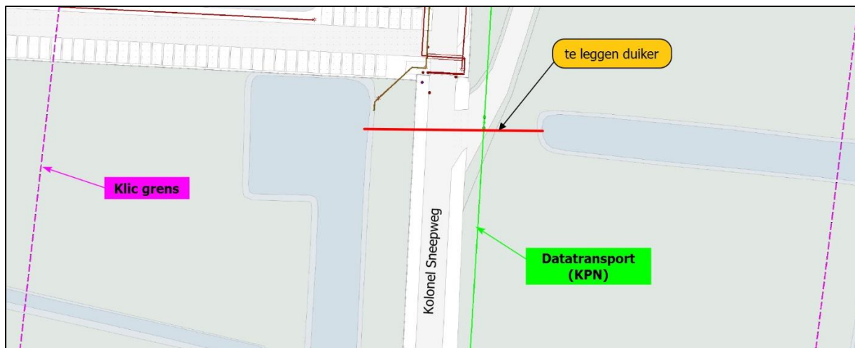
Figuur 33 – overzicht aanwezige kabels en leidingen in de Kolonel Sneepweg t.h.v. de te leggen duiker
