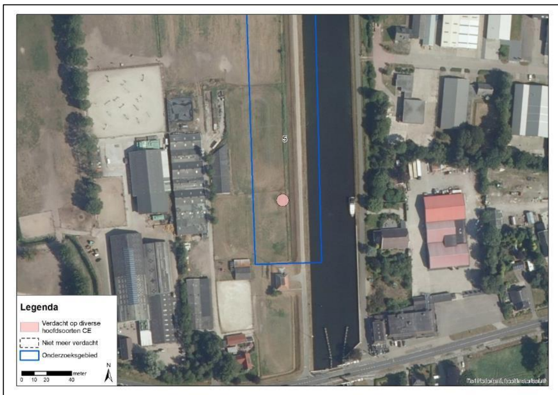
Afbeelding 34: weergave van de op de voorgaande foto afgebeelde verdachte gebieden met hierop aangeduid welke delen van deze verdachte gebieden komen te vervallen. Het kanaal werd namelijk op verschillende plaatsen verbreed of dichtgelegd. Op bovenstaande foto komen geen verdachte gebieden te vervallen.
