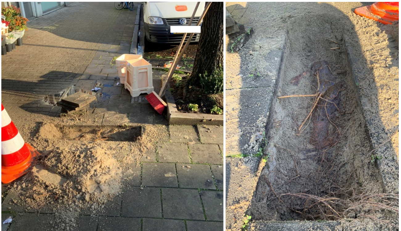
Foto 3: Bij de oudere iepen in de Kanaalstraat is grove beworteling aangetroffen. Profielsleuf 4 is hiervan een exemplarisch voorbeeld. De bodem bestaat uit uiterst humusarm zand tot 90 cm onder het maaiveld. Daaronder bevindt zich klei met de grondwaterverzadigde zone op 110 cm onder het maaiveld. De wortel rechts op de foto heeft een diameter van 20 cm.
