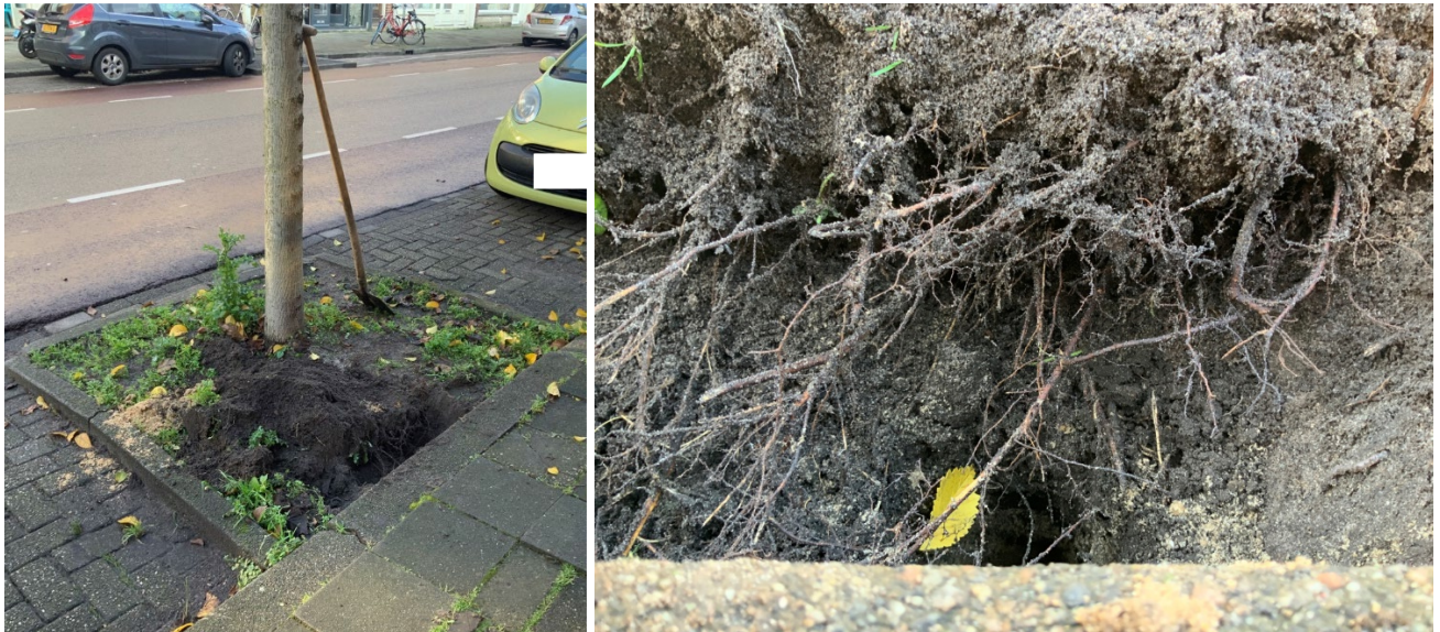
Foto 2: Bodemprofiel 1 en beworteling bij een jonge iep (boomnummer 1931374). Het in de boomspiegel aanwezige bomenzand is intensief doorworteld. Tot een diepte van 60 cm is bomenzand aangetroffen, daaronder bevindt zich klei, waarbij op 110 cm de grondwaterverzadigde zone is aangetroffen.
