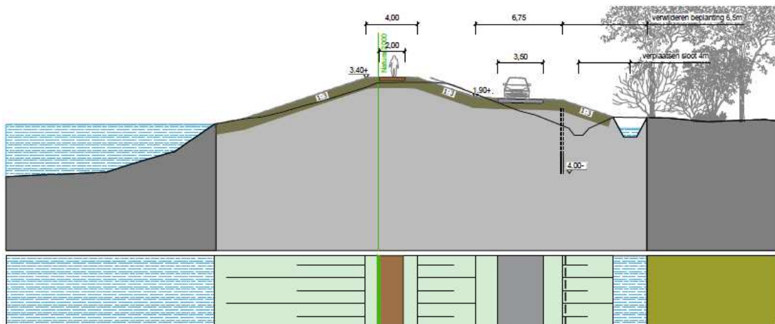
Figuur 2.55 Dwarsprofiel met groene kering, stabiliteitsberm, pipingscherm en wandelpad t.h.v. het toegankelijke deel van de dijk (DP96)
