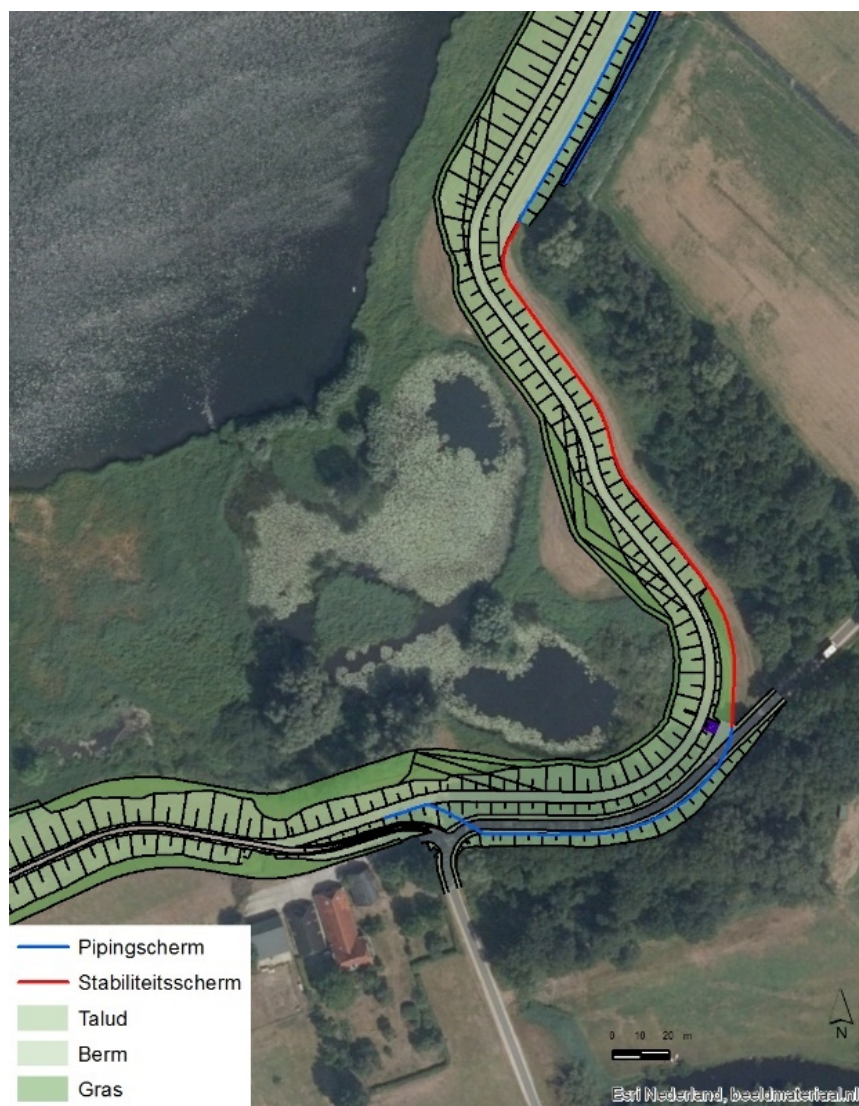
Figuur 2.59 Impressie van grondoplossingen, piping- en stabilisatieschermen in deelgebied 5
