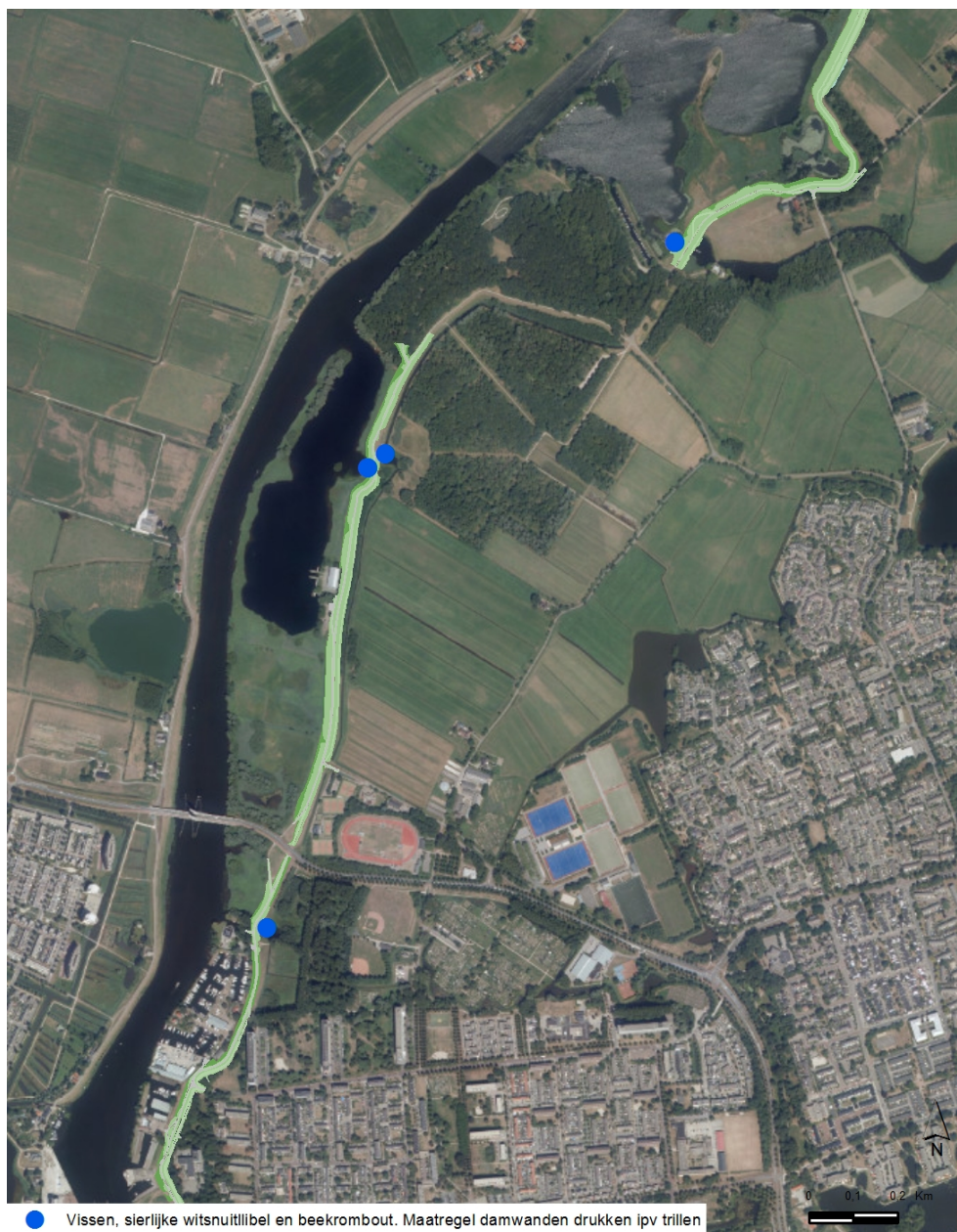
Figuur 3.216 Locaties waar damwanden worden gedrukt in plaats van getrild omdat deze nabij een oever worden geplaatst
