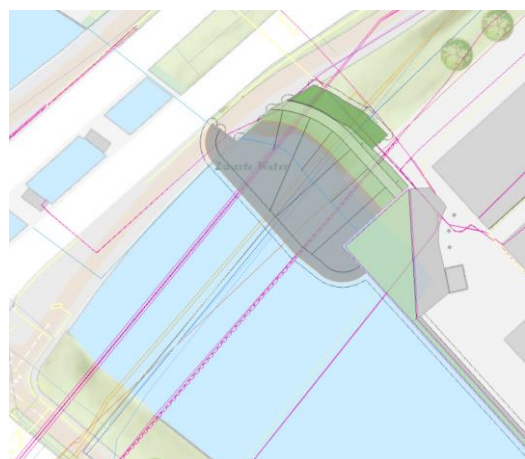
Figuur 9-3 Overzicht kruisende kabels en leidingen
