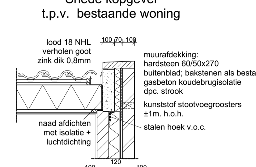
Sneede kopgevel t.p.v. uitbreiding
