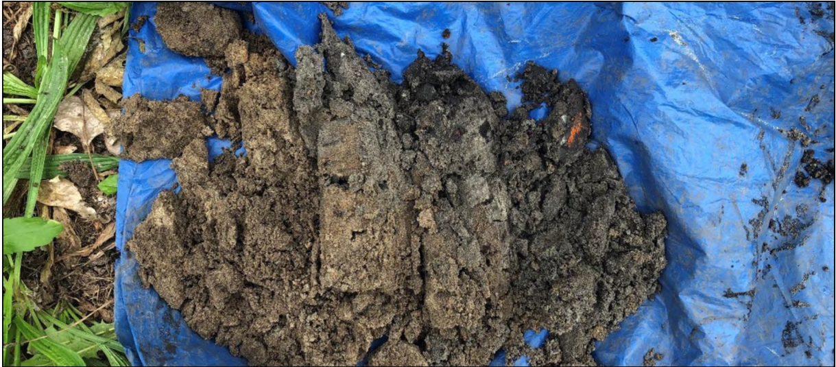
Boring 12: één van de gestaakte pogingen. In het ophoogzand is grof oranje-rood puin en kalkmortel aanwezig. Deze boring is uitgevoerd ter plaatse van het erf.
