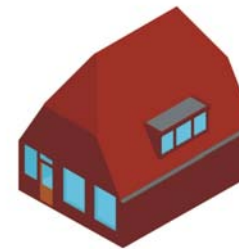
geen dakkapel op wolfseind, maar op zijdakvlak
