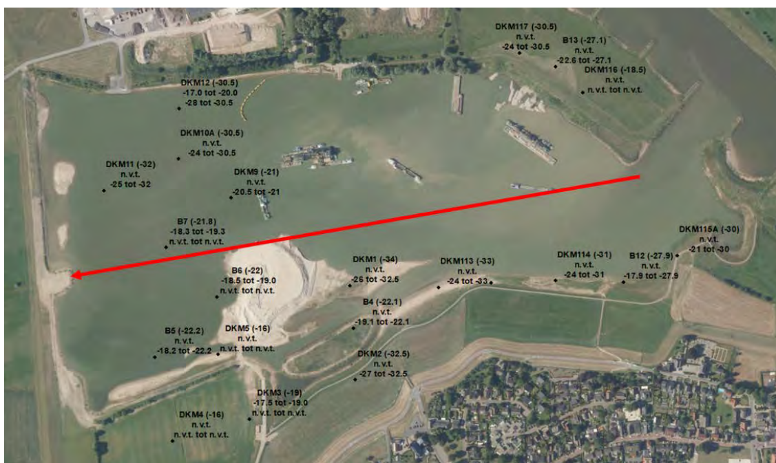
Figuur 1 Locatie Sonderingen + diepteligging kleilaag. Bron [ii, iii, iv, v en vi]
