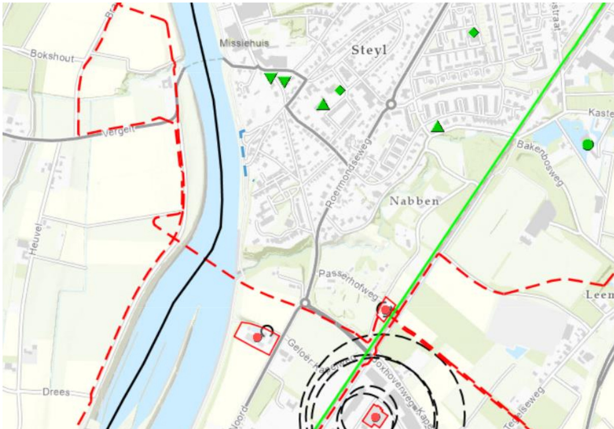
Figuur 23 Uitsnede risicokaart met het dijktraject (blauwe gestreepte lijn), buisleidingen (rode gestreepte lijn), risicovolle inrichtingen (rode stip), risico-contouren 10-6 (zwarte gestreepte lijn), basisnet binnenvaartroutes (zwarte lijn), basisnet weg (groene lijn) en kwetsbare objecten (groene figuren).
