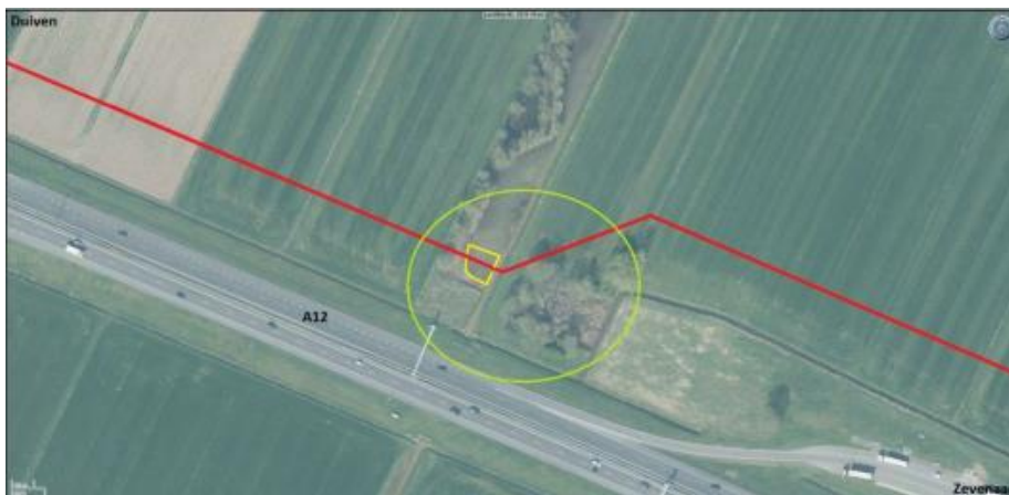
Figuur 5: Ligging van de te plaatsen rioolpersleiding (rode lijn), het gebied dat mogelijk aangetast wordt (geel vlak) en het onderzoeksgebied (groene cirkel)
