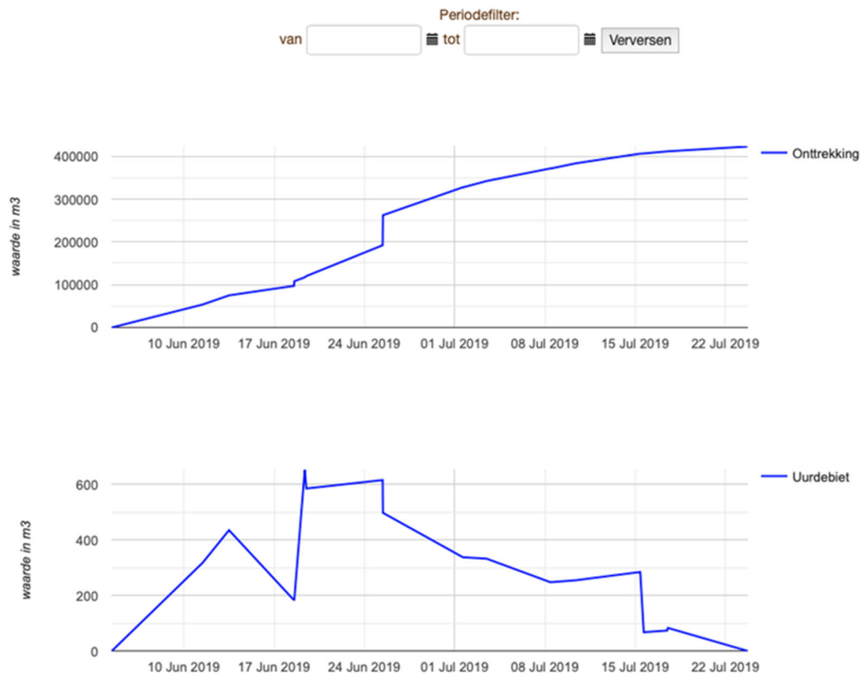
Afbeelding 25. Hoeveelheden fase 3, verwijderen gasleidingen en waterleiding, ontleend aan eigen registratiesysteem Gasunie.
