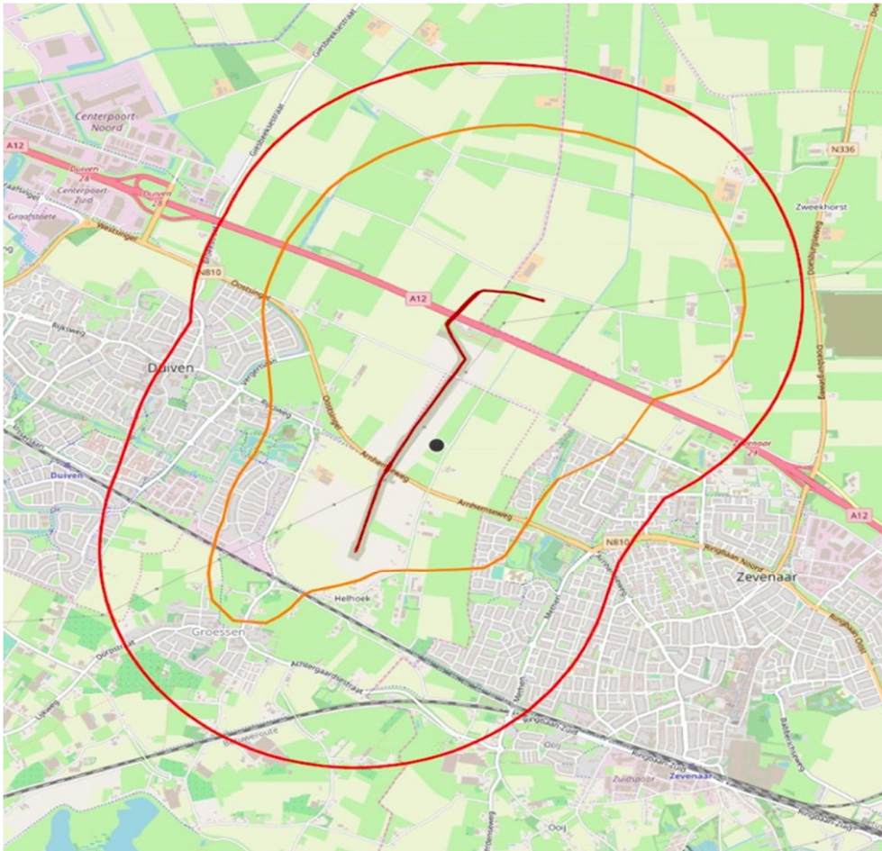
Afbeelding 18. Werkelijke 0,05 m verlagingsslijn (oranje) t.o.v. de berekende invloedssfeer (rood) op basis van de GLG tijdens aanleg van de gastransportleidingen. Ontleend aan eigen GIS-Data Gasunie.
