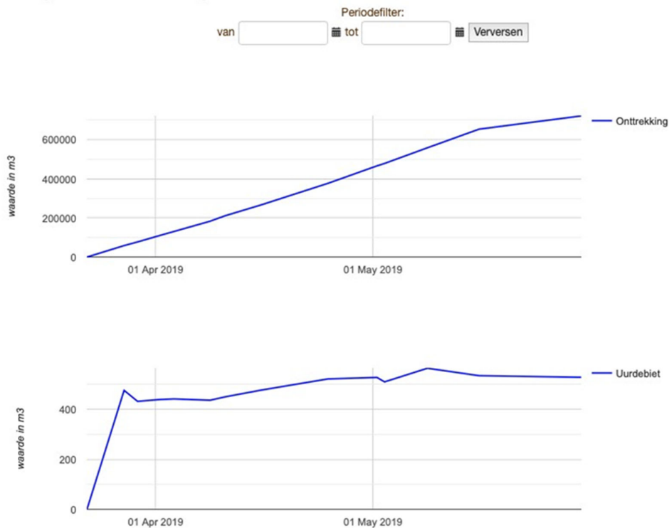
Afbeelding 23. Hoeveelheden fase 2, TIE-IN noordzijde A12., ontleend aan eigen registratiesysteem Gasunie.
