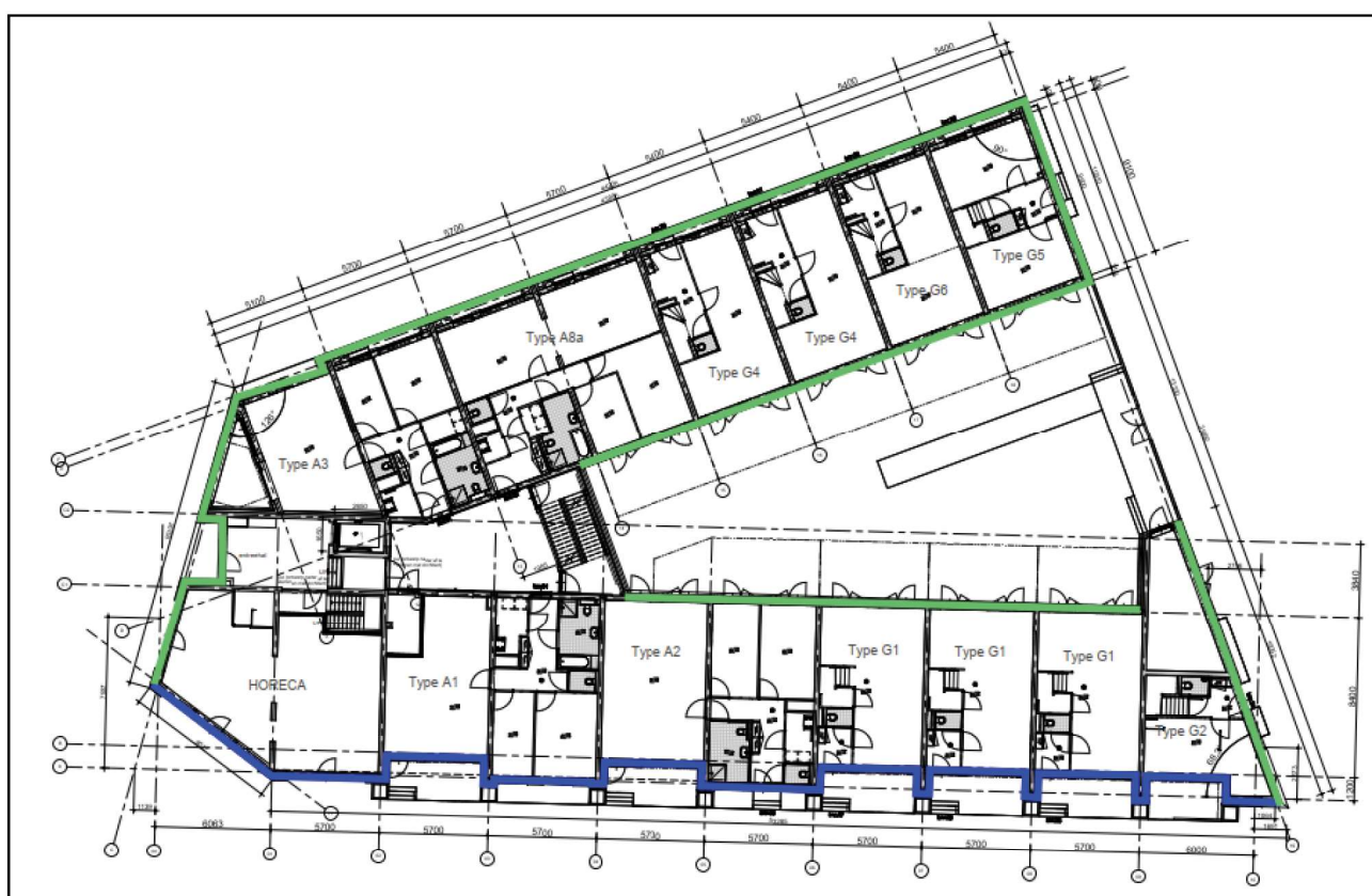
Figuur 9.3: Weergave geluidwerende voorzieningen in de geveltekeningen (groen: standaard HR++ glas, blauw: SGG Climalit Silence 35/42 AST)
