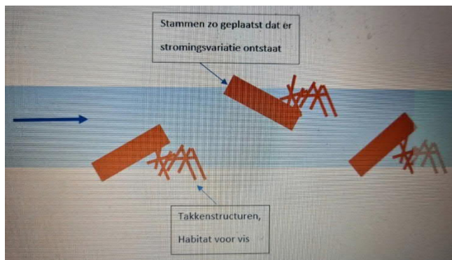
dood hout in visgraatmotief, compact aangelegd, met meer afstand tussen stammen wordt het doorstroomprofiel groter.
