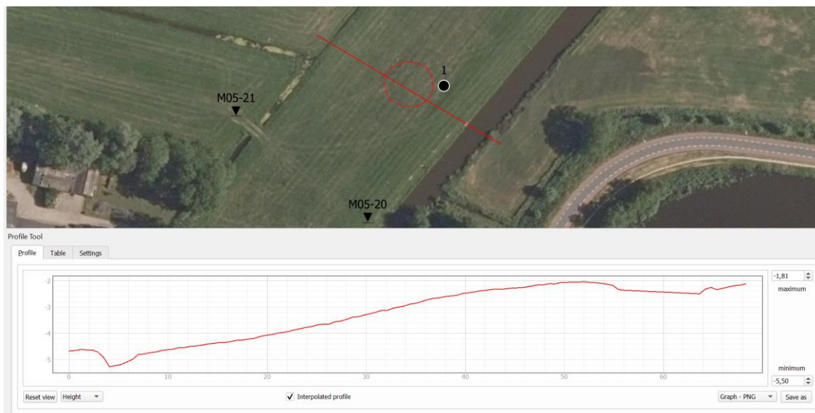
Figuur 2-1: Bovenaanzicht en dwarsprofiel over dijklichaam conform AHN3
