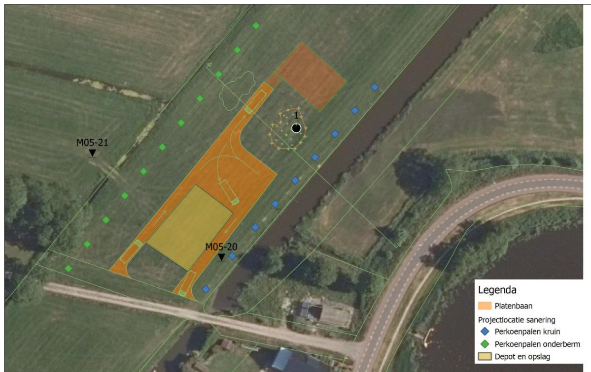
Figuur 2-2: Bovenaanzicht saneringslocatie met platenbaan en perkoenpalen
