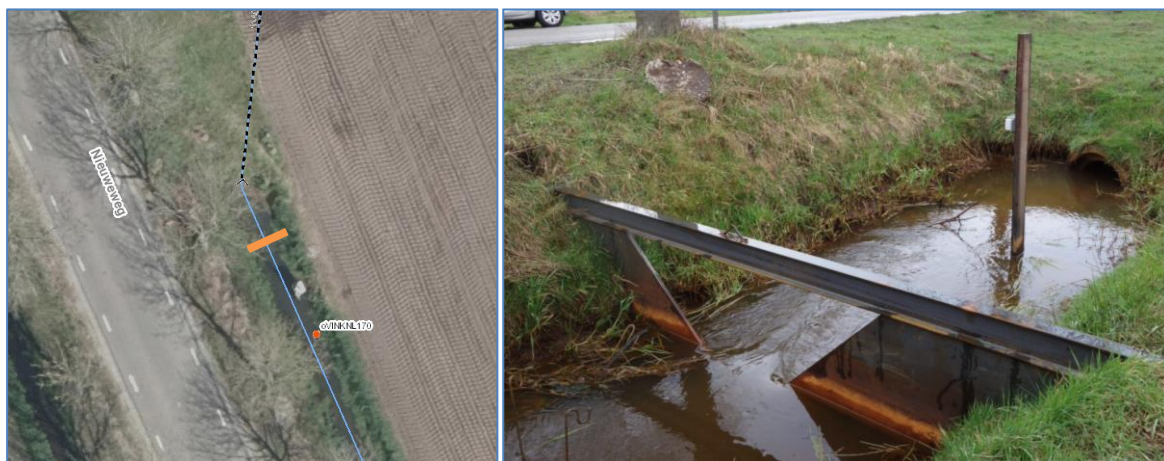
Figuur 2-1 de ligging van de meetschot (oranje lijn) in de Vinkenloop, Westerbeek, kruising Nieuweweg en Stevensstraat) (links) met een overzicht van het meetschot.
