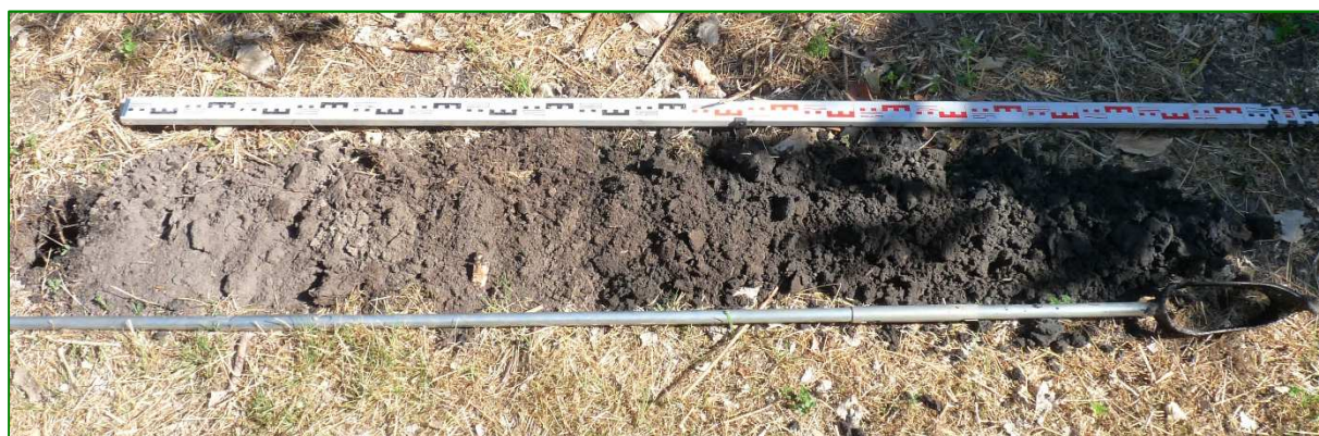
Afbeelding 15: Geen grondwater aangetroffen tot een diepte van 190 cm-mv
