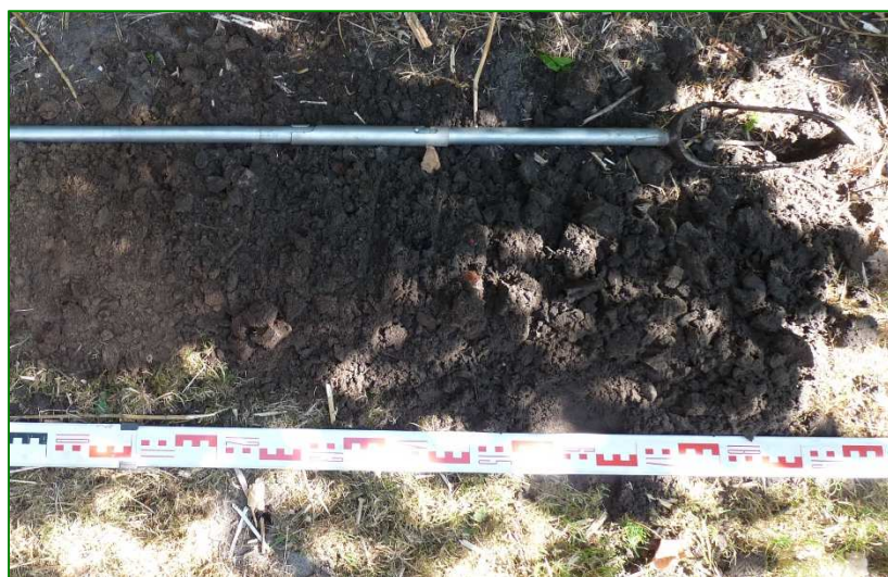
Afbeelding 14: Geen grondwater aangetroffen tot een diepte van 190 cm-mv
