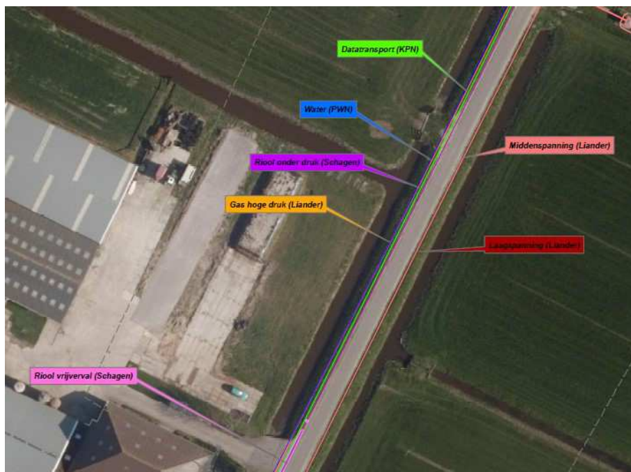
Figuur 13: Kabels en leidingen langs de Molenweg
