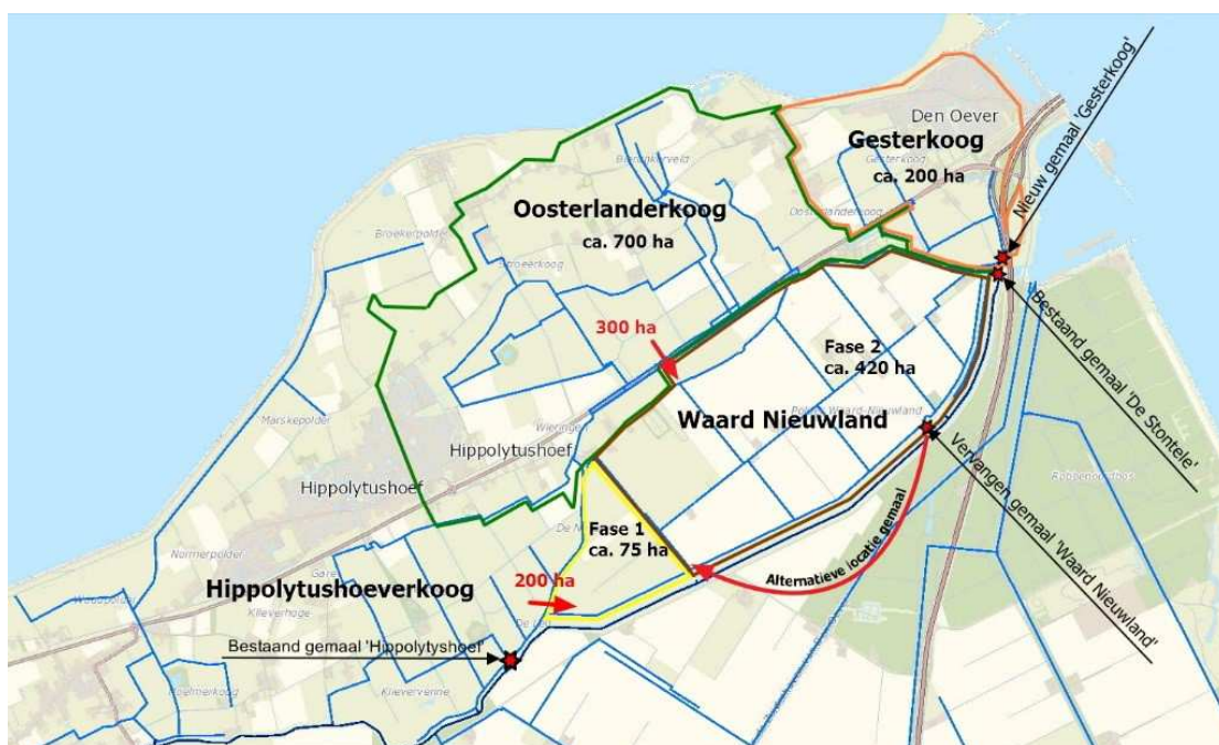
Sinds de uitvoering van het projectplan Gesterkoog (eind 2017) watert het gebied de Gesterkoog niet meer af op de polder Waard-Nieuwland (figuur 4). Daar staat tegenover dat in de toekomstige situatie, wanneer maatregelen zijn uitgevoerd in de polder Oosterlanderkoog, een deel van het watersysteem van de polder Oosterlanderkoog wel wordt afgevoerd naar de polder en het nieuw te bouwen gemaal Waard-Nieuwland. Deze overige maatregelen worden op dit moment verkend en zullen in een nog op te stellen projectplan worden opgenomen.
