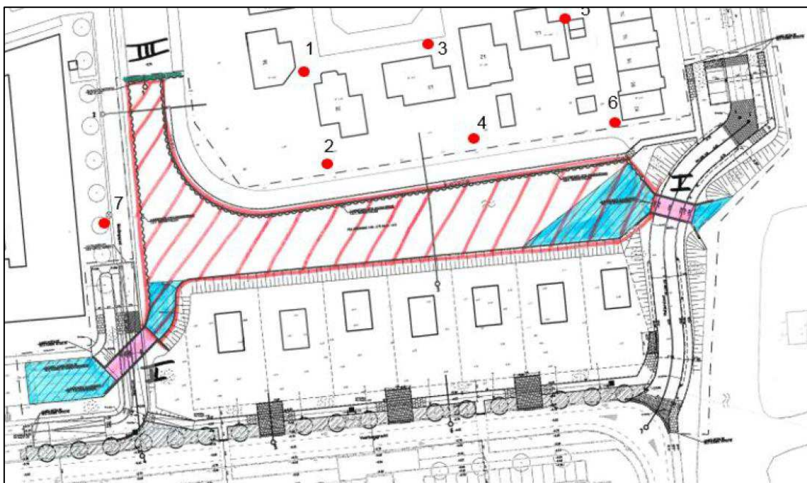
Figuur 3.2 – Toekomstige situatie inclusief de locatie van de peilbuizen van de grondwatermonitoring
