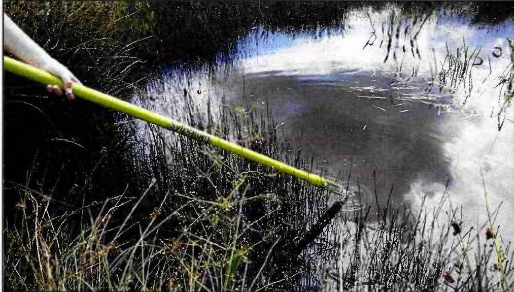
Afbeelding 1. Monsterhengel Sylphium. Aan het eind van de hengel wordt een DNA schone spuit geplaatst waarmee watermonsters worden genomen. (bron: Sylphium, 2018').
