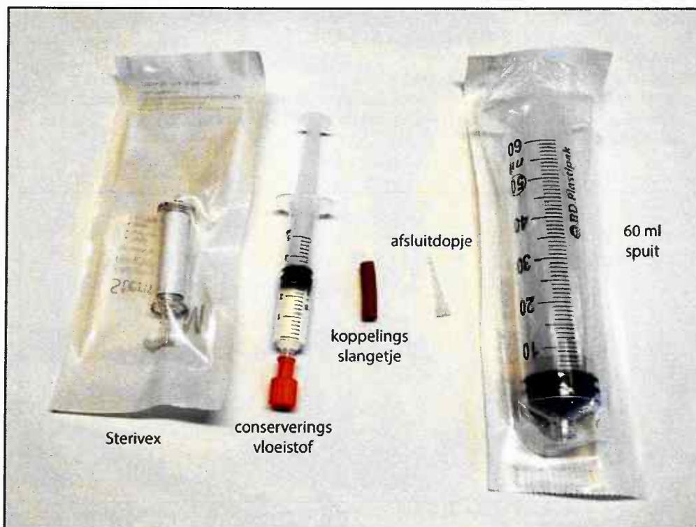
Afbeelding 2. Inhoud bemonsteringskit; 60 ml steriele spuit voor bemonstering, steriel Sterivex filter, injectiespuit met conserveringsvloeistof, koppelslangetje en een afsluitdopje. (bron: Sylphium, 2018 1 ).
