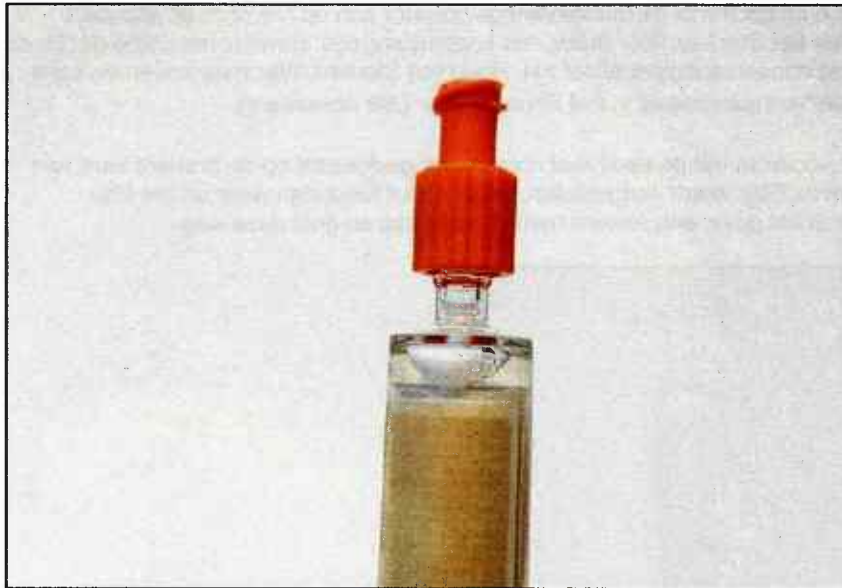
Afbeelding 7. Sluit met rubber schroefdop, ene zijde van het filter af (bron: Sylphium, 2018').
