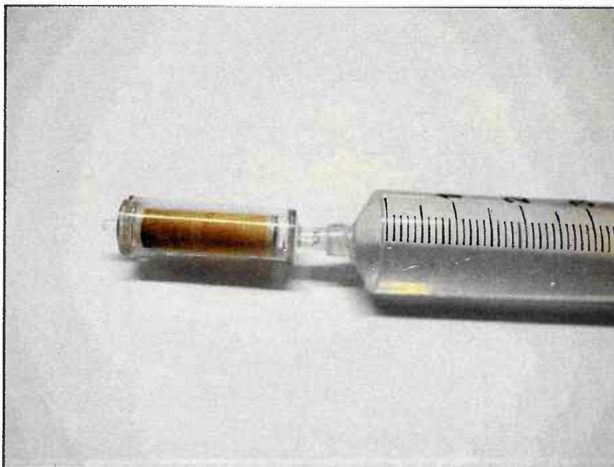
Afbeelding 5. Bevestiging Sterivex filter aan 60 ml injectiespuit. (bron: Sylphium, 2018 1 ).
