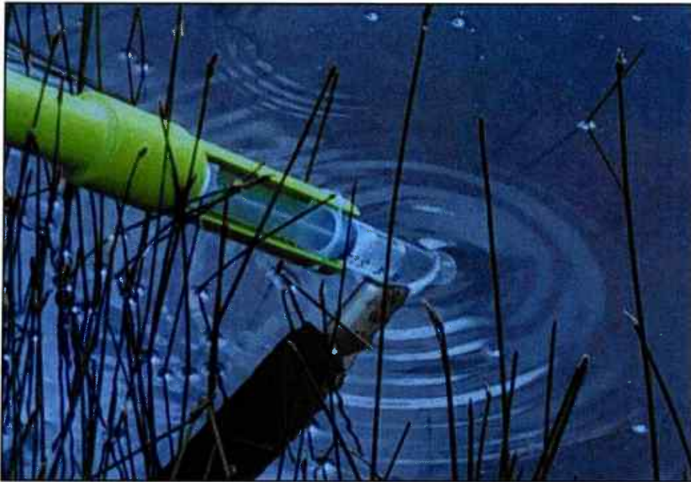
Afbeelding 4. Plaatsing van de 60 ml steriele injectiespuit voor bemonstering in de monsterhengel. De monsterhengel raakt het water niet. (bron: Sylphium, 2018').
