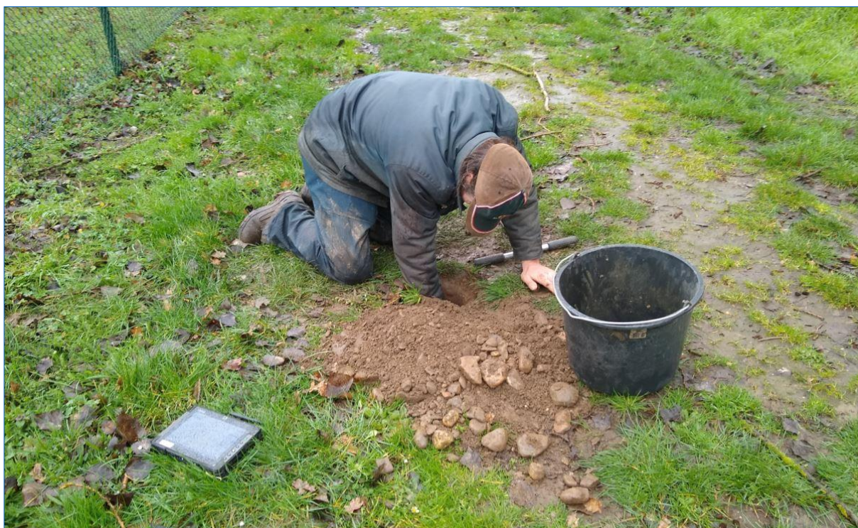
Figuur 3. Een laag met vuistdikke keien belemmerde het boren en moest eerst handmatig verwijderd worden.
