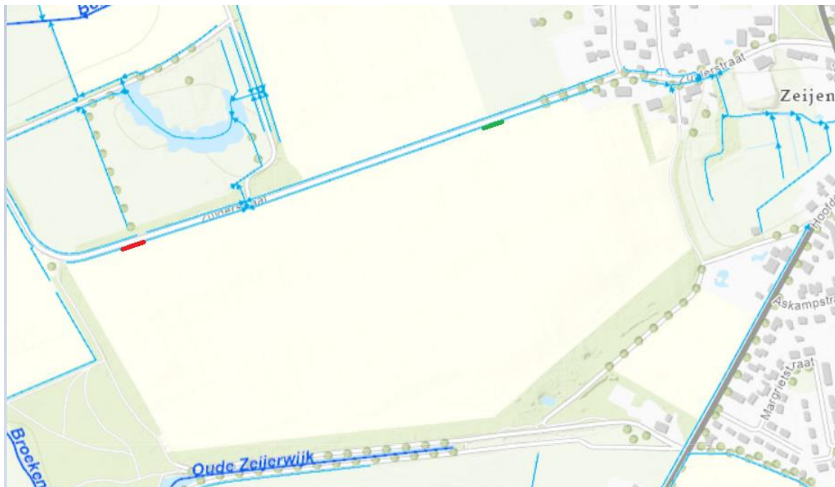
Figuur 1: locatie van de werkzaamheden met in het rood aangegeven de te verwijderen dam met duiker en in het groen de te plaatsen dam met duiker.
