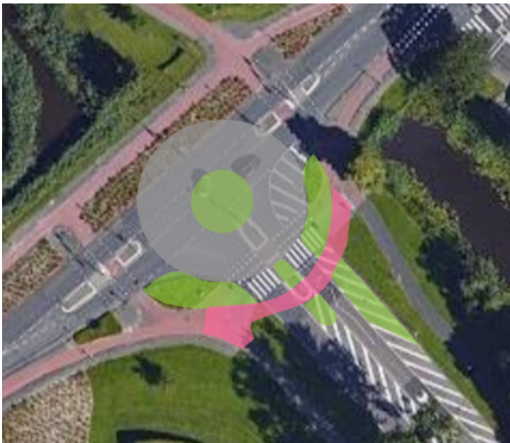
Figuur 10: Schets van een tijdelijke rotonde en veilige fietsoversteek parallel aan Vijverlaan
