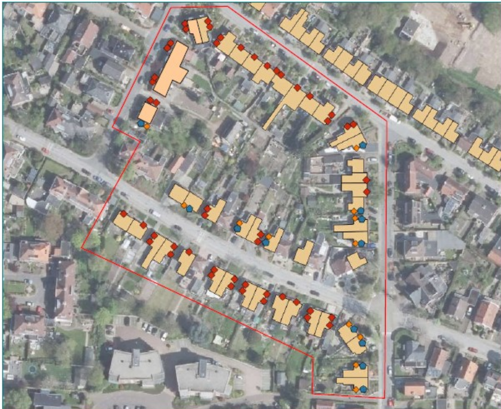
Figuur 1: Overzicht plangebied met te renoveren woningen (gearceerde woningen binnen het rode kader) en de locaties met aan te brengen tijdelijke en permanente kasten.
