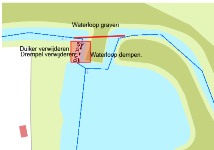
Figuur 11: Voorgestelde aanpassing verwijderen omloop stuwvijver watermolen Bels. Ten behoeve van de habitattypen wordt de drempel voor de molen van de drie stuwjes vlak voor de geleidegoot naar het waterrad van watermolen Bels. Voorstel Ben Ordelmans, Waterschap Vechtstromen.
