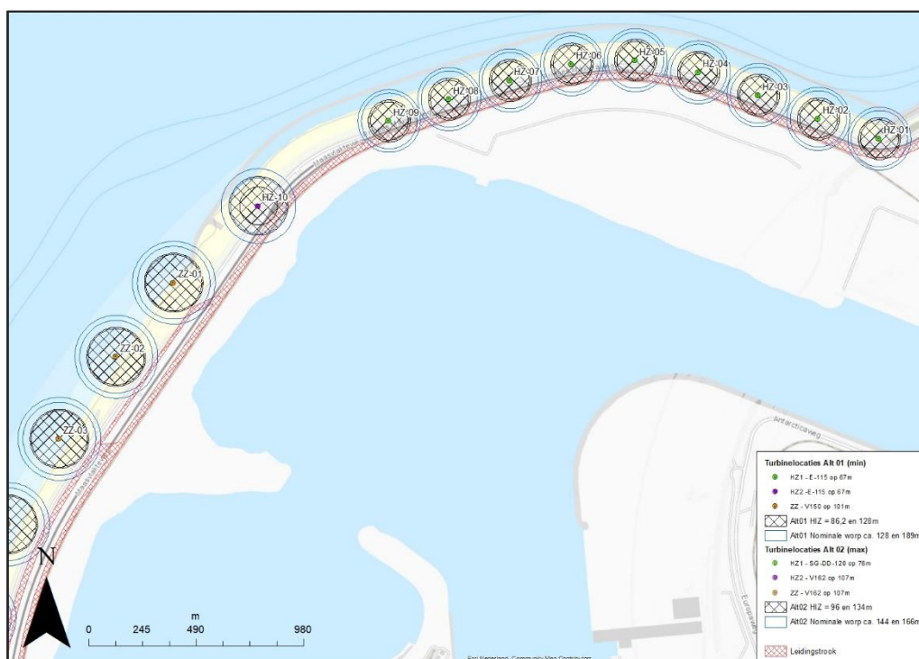
Figuur 8.8 Weergave buisleidingstroom i.r.t. windpark deelgebied Noord
