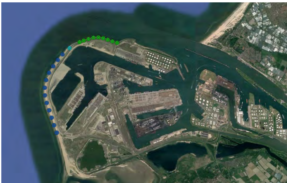
Figuur 1.1 Overzicht van het windpark Maasvlakte 2. De groene stippen geven de locaties weer van de windturbines op de 'harde' zeewering, terwijl de blauwe stippen de windturbines op de zachte zeewering weergeven. Bron: Turbinelocaties.kml , 26-11-2019.
