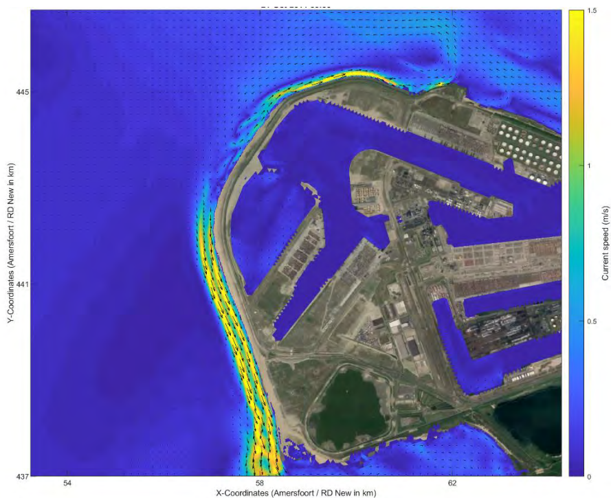
Figuur 3.7 Voorbeeld van de golfgedreven langstromingen berekend met Delft3D-FM voor de 2019 bodem.
