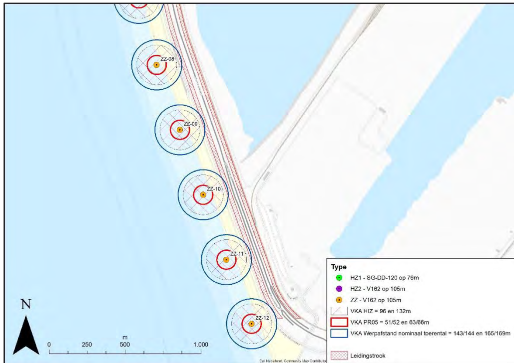
Figuur 10.9 Weergave buisleidingstrook i.r.t. windpark deelgebied Zuid-2
