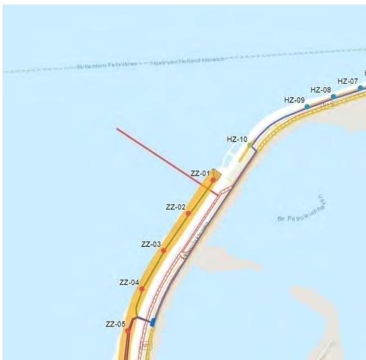
Figuur 3-6. Locaties van de windturbines op de zachte zeewering (rode punten) en het begin van de overgangszone (rode lijn).
