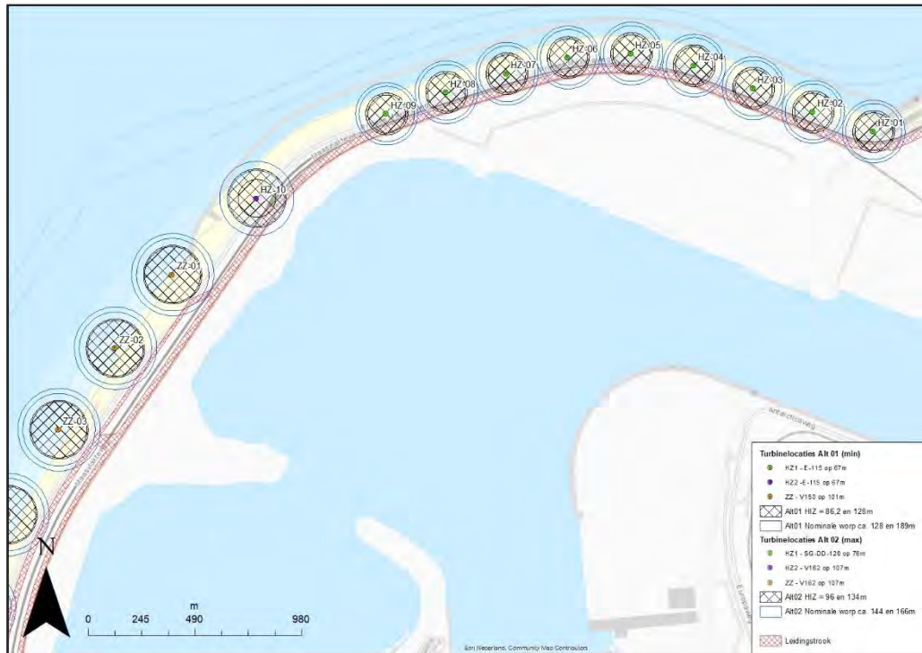
Figuur 5.3 Weergave buisleidingstrook i.r.t. windpark deelgebied Noord
