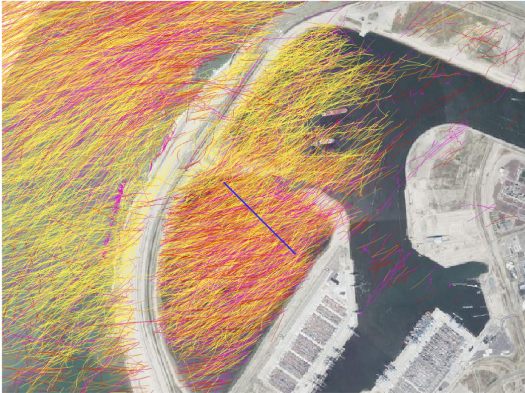
Figuur 6.3 Vliegpaden van kleine vogels (geel), middelgrote vogels (oranje), grote vogels (rood) en groepen (paars) die op 20 oktober 2019 tussen 19:00 en 19:10 (UTC) op de Tweede Maasvlakte door de vogelradar zijn geregistreerd (uit: Kleyheeg-Hartman & Potiek 2020a). Met name in de oostelijke helft van dit beeld (en boven de dijk zelf) had de radar geen goed 'zicht' vanwege obstructies en reflecties door bijvoorbeeld hekwerken, schepen, containers etc.). De blauwe lijn heeft een lengte van 1 km en is gebruikt om het aantal passages per uur te onderzoeken en daarmee de MTR vast te stellen. De radar stond bovenop de zachte zeewering op parkeerplaats P6 (in het verlengde van de blauwe lijn).
