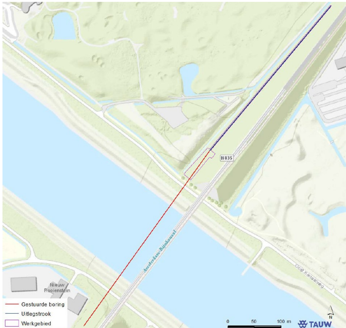
Figuur 2. Details van het plangebied ter hoogte van de Beldertsebrug/N835 bij Tiel waar de waterleiding onder het Amsterdam-Rijnkanaal wordt vervangen.
