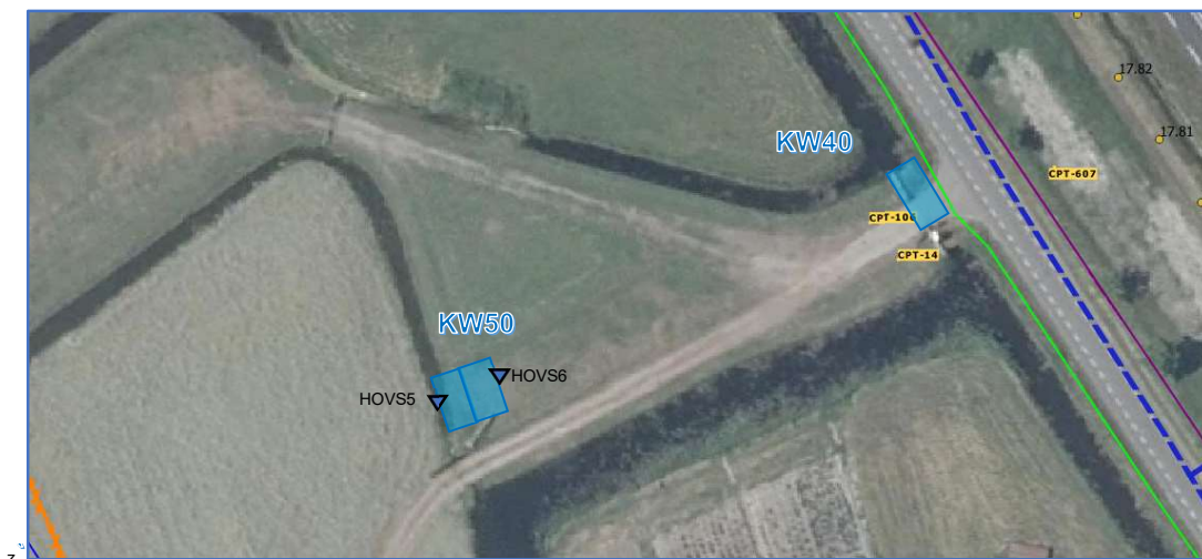
Figuur 5: Luchtfoto met overzicht van het beschikbare grondonderzoek i.r.t. en het nieuwe gecombineerde KW50 en de locatie van de voormalige locatie van duikerbrug KW 40.
