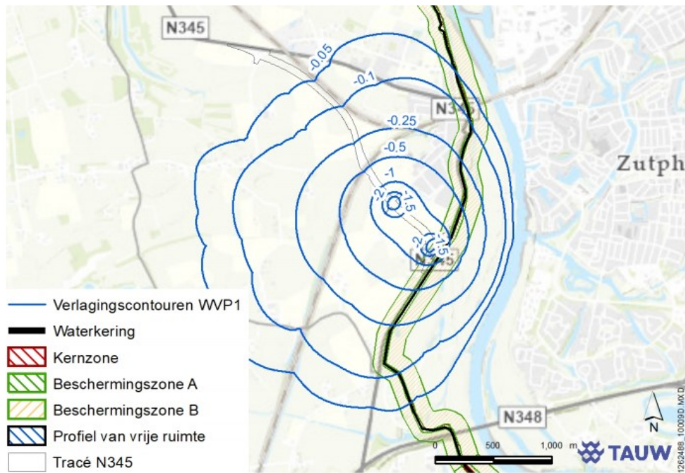
Figuur 4.3 Legger waterkering met kern- en beschermingszones (bron: waterschap Vallei en Veluwe)
