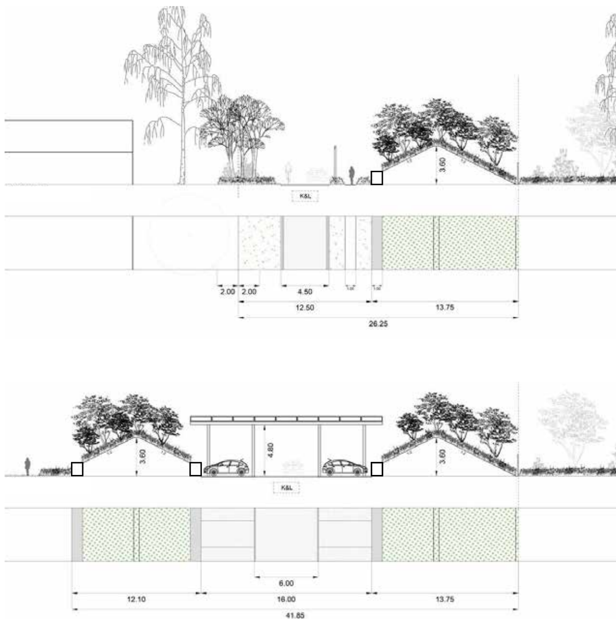
Profielen van de ecowal: basis en ter hoogte van zonnepergola
