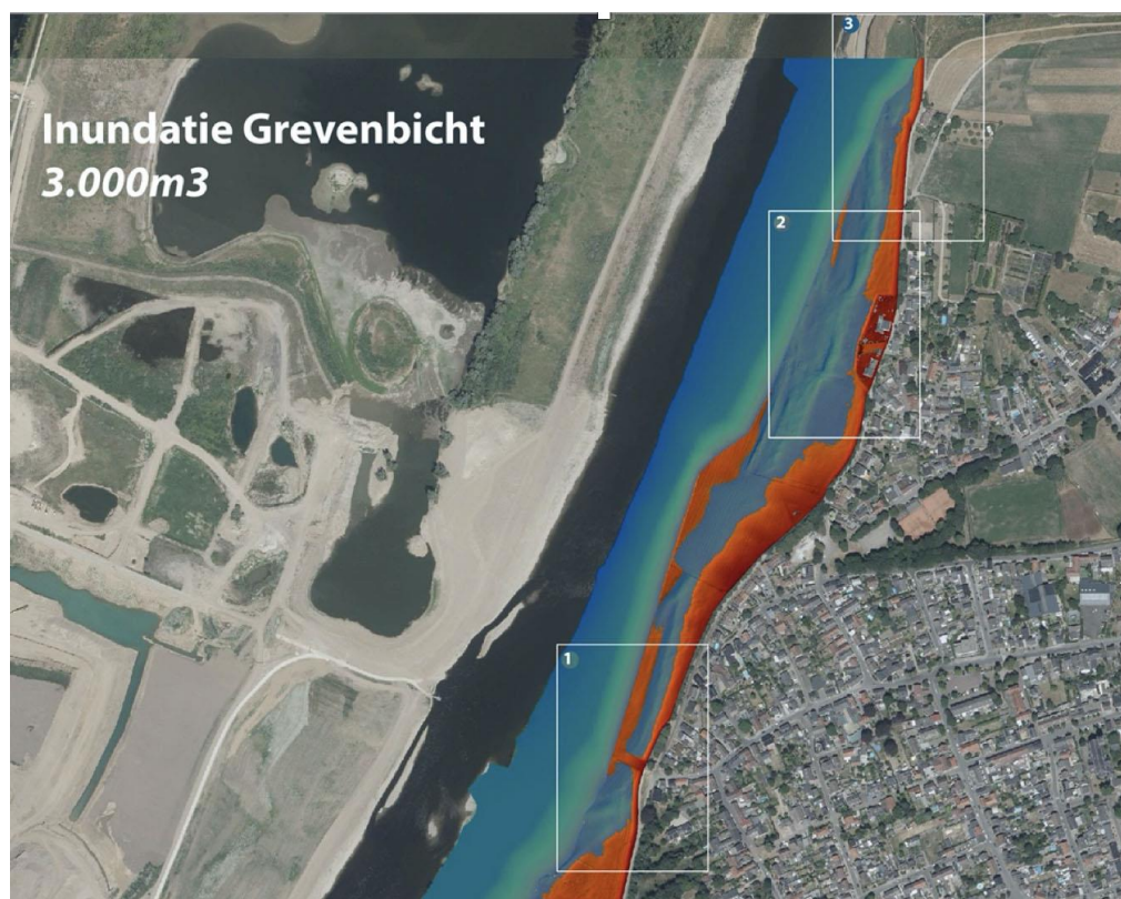
Figuur 1. Gebied dat bij een afvoer van 3000 m 3 /s overstromt. Er zijn drie locaties (binnen de kaders) waar het water vanaf een afvoer van ca 1800 m 3 /s al tot aan de waterkering reikt waardoor de passage voor grazers vanuit Koeweide naar het zuiden wordt belemmerd.
