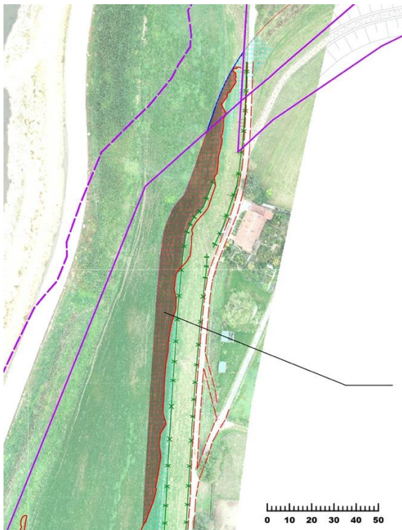
Figuur 5. Gebied dat opgehoogd wordt ter plaatse van locatie 3. Oppervlakte: ca 1500 m 2 , inhoud: ca 650 m 3 . De hoogte waarop deze locatie wordt gelegd bedraagt 31,3 m +NAP.
