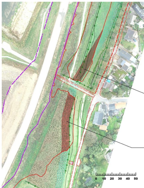
Figuur 3. Gebied dat opgehoogd wordt ter plaatse van locatie 1. Oppervlakte: ca 1200 m 2 , inhoud: ca 900 m 3 . De hoogte waarop deze locatie wordt gelegd bedraagt 31,6 m +NAP.
