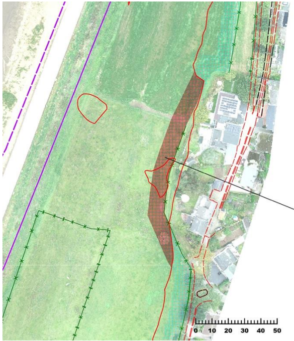
Figuur 4. Gebied dat opgehoogd wordt ter plaatse van locatie 2. Oppervlakte: ca 1100 m 2 , inhoud: ca 300 m 3 . De hoogte waarop deze locatie wordt gelegd bedraagt 31,6 m +NAP.
