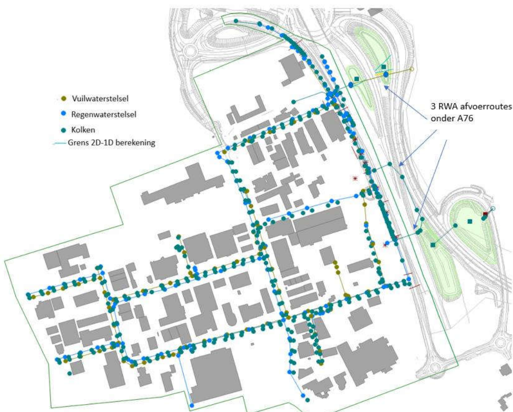
Figuur 3-1 Weergave 2D-1D rekenmodel De Horsel – Reijmersbekerweg te Nuth
