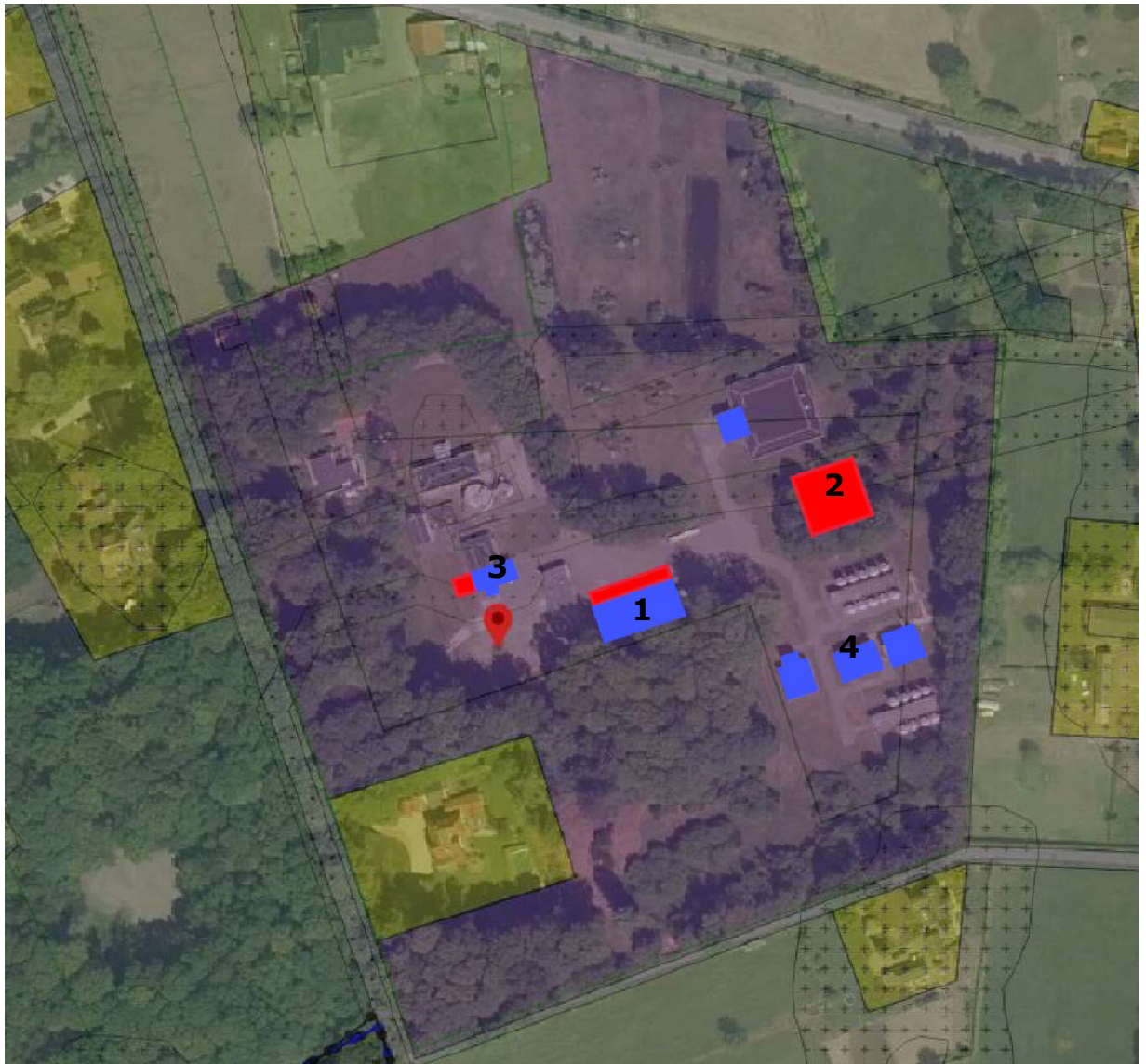
Figuur 1: Technische tekening geplande werkzaamheden productiebedrijf Diepenveen (rood: nieuwe onderdelen; blauw: inpassing aan te passen onderdelen), kaart gericht richting het noorden.
