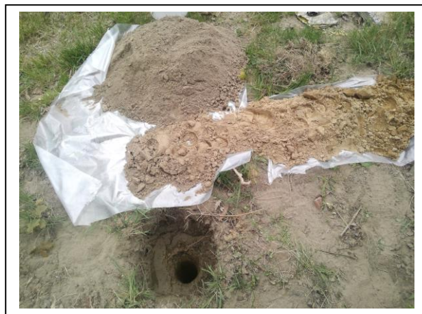
Foto: Inspectiegat A09
