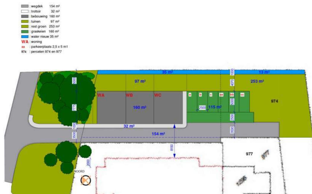
Fig. 5.5 Overzicht verharding / groen
