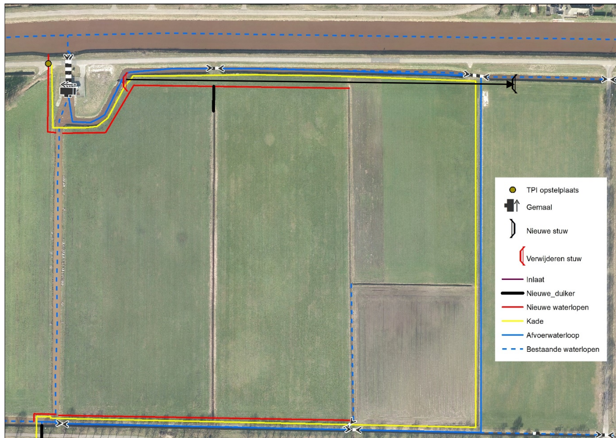
Figuur 10 Verplaatsing van stuw ST02948
