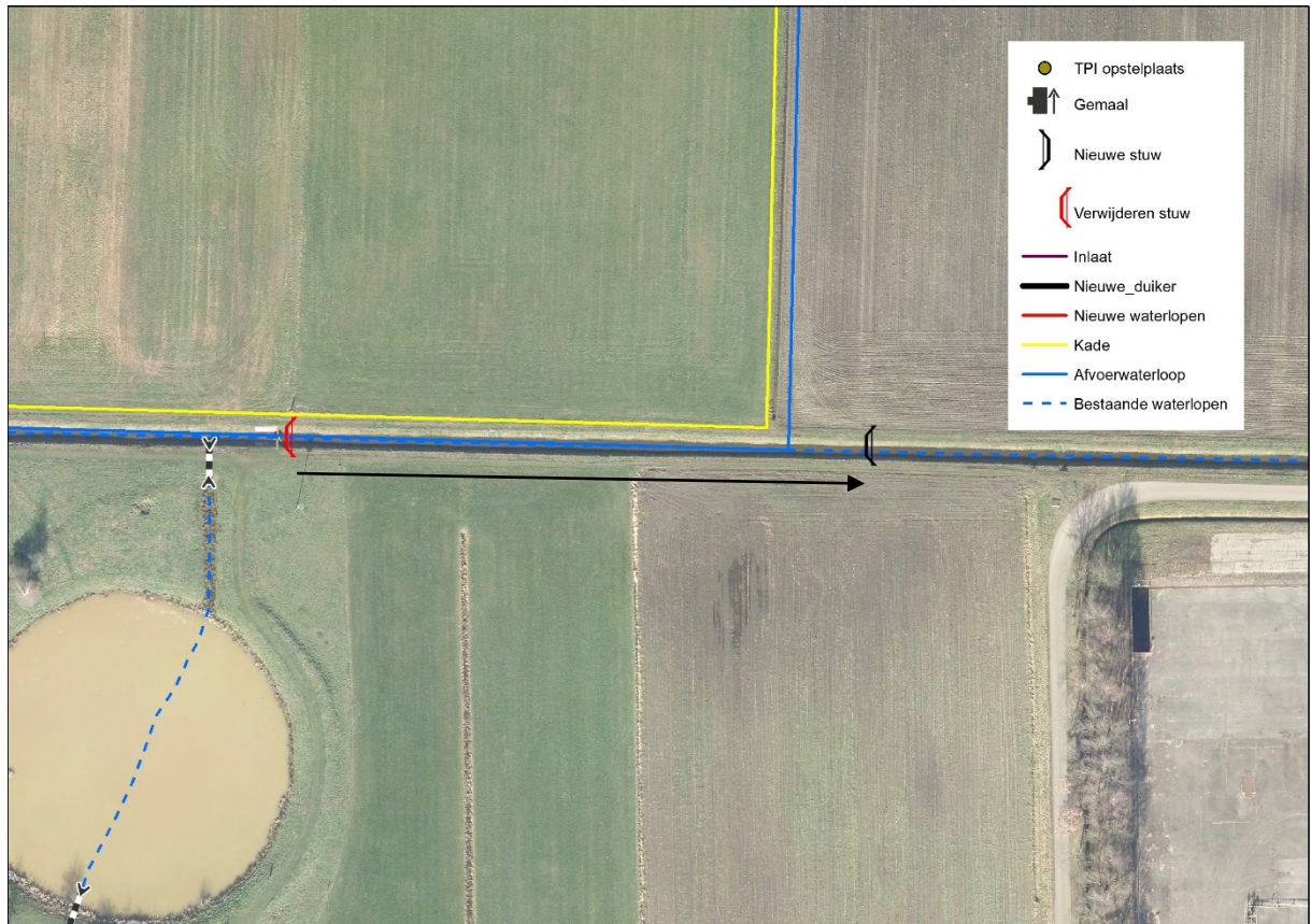
Figuur 11 Verplaatsing van stuw ST03596
