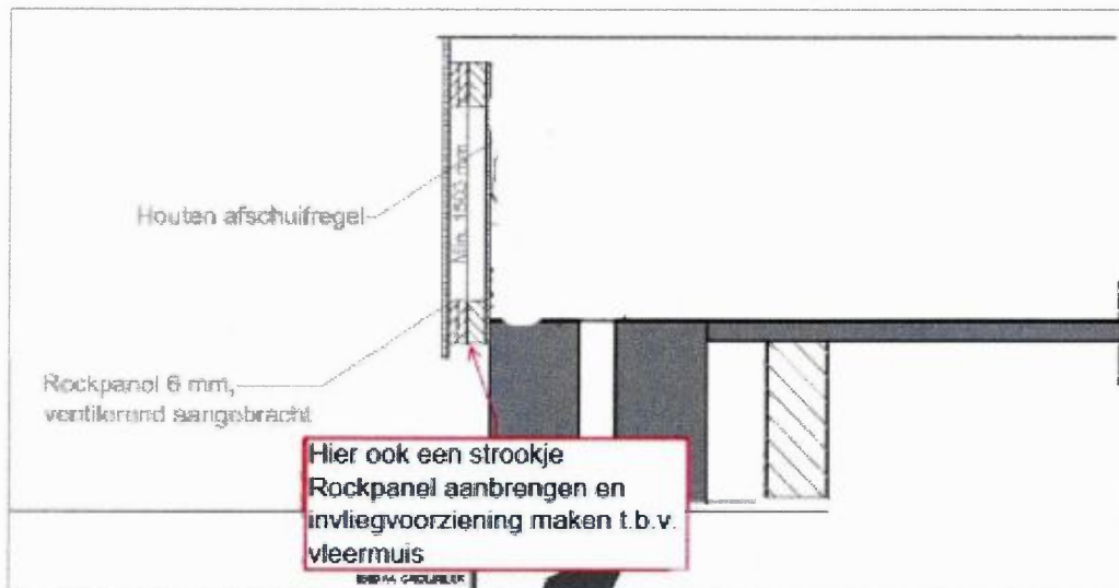
Figuur 13.3. Inbouwvoorzieningen voor de vleermuis
