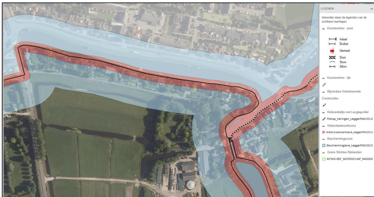
Figuur 5 Uitsnede van legger Regionale Keringen met de kering Kollensloot en Kromme Mijdrecht (zwarte lijn) en bijbehorende zone waterstaatswerk (rood) en beschermingszone (blauw).
