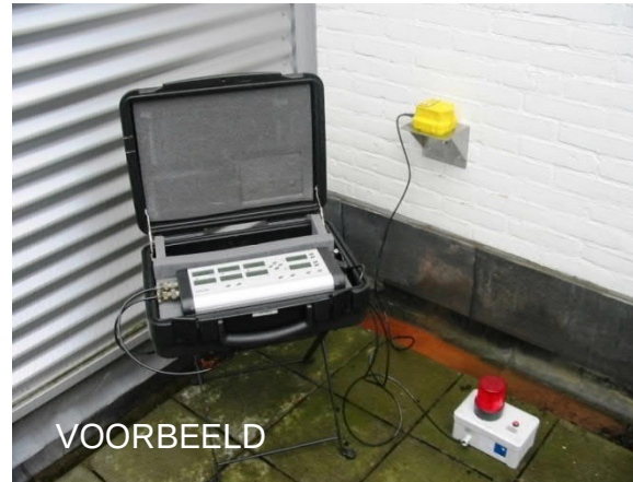
Figuur 5 Voorbeeld trillingsmeetapparatuur
