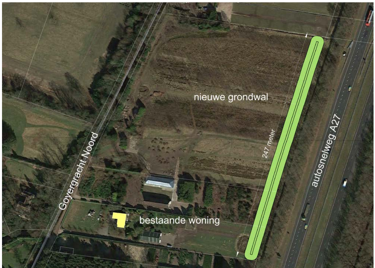
Figuur 3.2: Ontwerp grondwal
