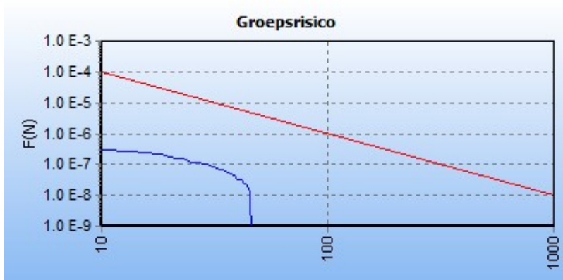
5.2 Figuur 5.2 FN curve voor 6952_leiding-W-535-01-deel-1 van N.V. Nederlandse Gasunie voor de kilometer tussen stationing 2750.00 en stationing 3750.00
