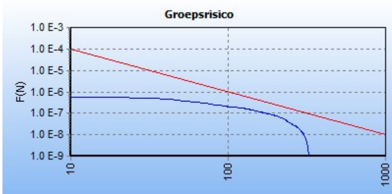
5.2 Figuur 5.2 FN curve voor 6952_leiding-W-535-01-deel-1 van N.V. Nederlandse Gasunie voor de kilometer tussen stationing 2750.00 en stationing 3750.00
