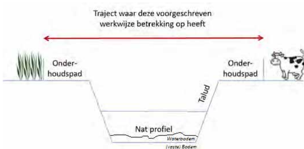
Figuur 1: Traject waar het beheer en onderhoud zich op richt bij het onderhouden van watergangen. (bron: Gedragscode Wet natuurbescherming voor waterschappen, 2019).
