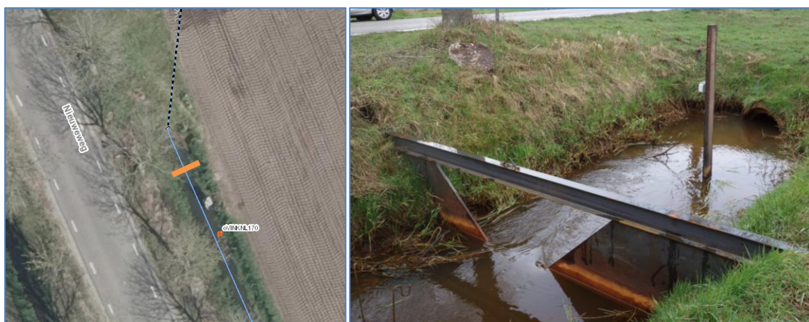
Figuur 2-1 de ligging van de meetschot (oranje lijn) in de Vinkenloop, Westerbeek, kruising Nieuweweg en Stevensstraat) (links) met een overzicht van het meetschot.
