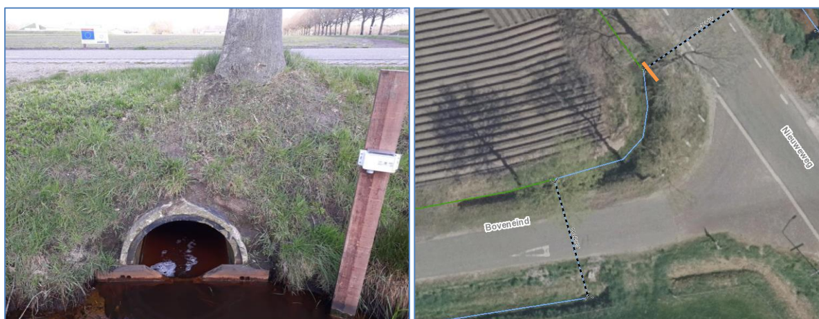
Figuur 2-5 Het meetschot met waterstandmeter voor bepalen afvoer in de Vinkenloop bij meetlocatie xVINKNL125.
