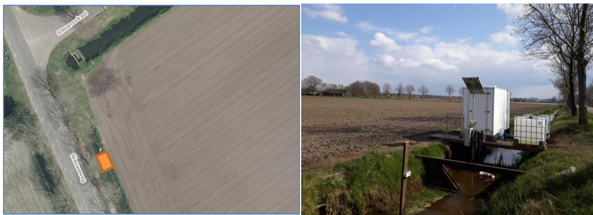
Figuur 2-4 locatie van de meettrailer (links) en overzicht van de meetopstelling op meetlocatie 170 (rechts) met vooraan het meetschot met waterstandmeter (zie paragraaf 2.1), daarachter de opstelling met de sensoren (vrijgesteld object) en daar weer achter de meettrailer met opvangbakken.
