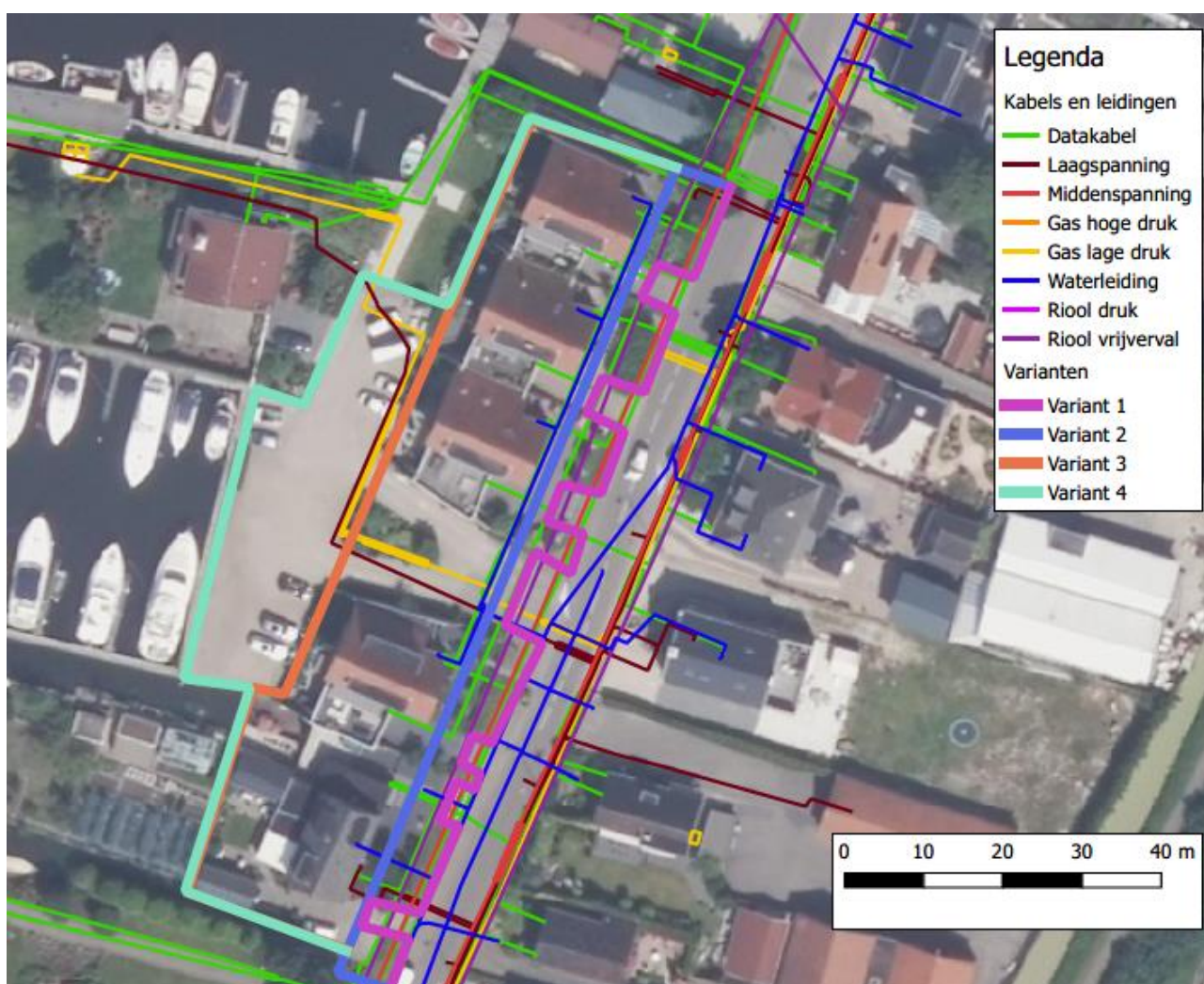
Figuur 4: Overzicht kabels en leidingen
